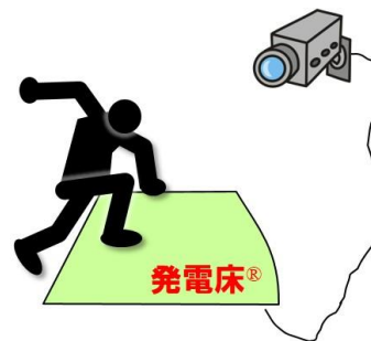
侵入者が発電床を踏んだ方向へカメラを向けて、侵入者の姿を映す。
